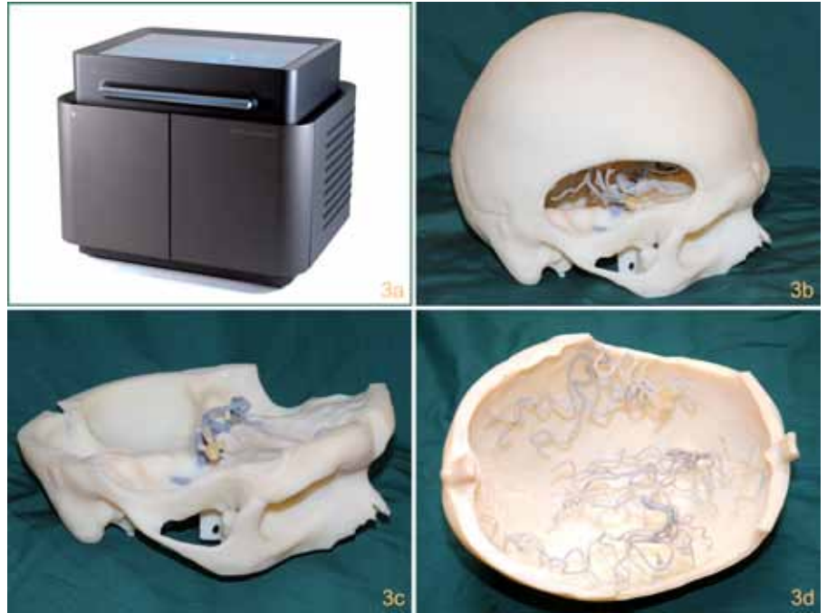
Nach Versuchen mit Stereolithografie entstehen heute die Modelle des Schädels und der zerebralen Blutgefäße aus unterschiedlichen Materialien im 3D-Druck.
