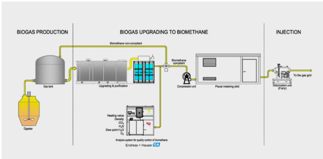
Als wichtiger Bestandteil von Aufbereitungsanlagen **überwachen Analysesysteme kontinuierlich die Qualitätsparameter des erzeugten Biomethans.**
