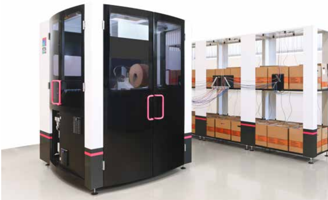
Auf Basis der Daten aus dem Digitalen Zwilling konfektioniert das Wire Terminal WT von Rittal vollautomatisch Drähte mit Querschnitten von 0,5 bis zu 2,5 mm 2 .
