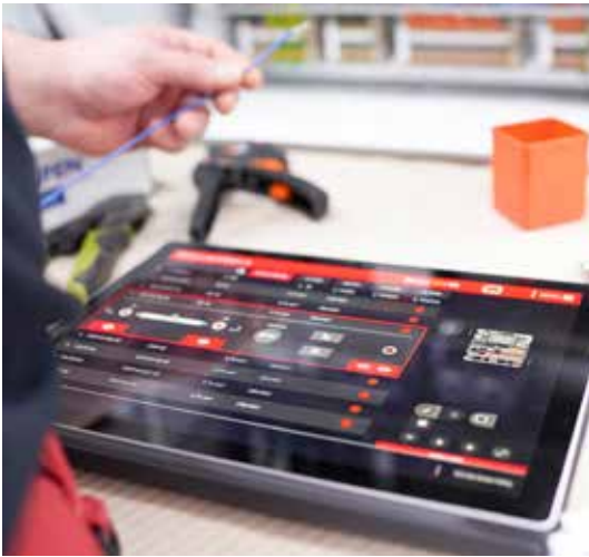
Eplan Smart Wiring fungiert als Verdrahtungs-Navi , indem es den Verdrahtungsprozess übersichtlich und Schritt für Schritt visualisiert, auch auf Mobile Devices.
