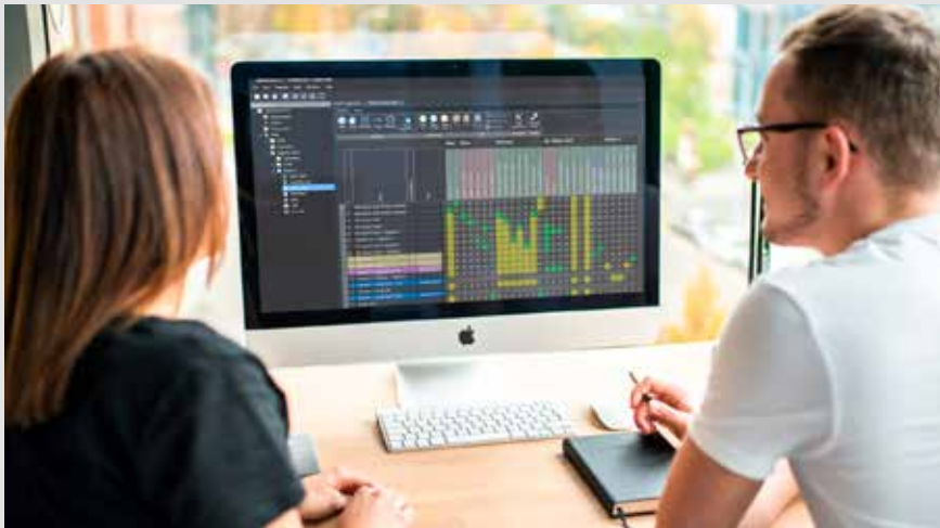
Das Modellieren der Ablaufschritte des Maschinenmodells erfolgt komfortabel und schnell auf einer grafischen Oberfläche im Logic Layer der Entwicklungsumgebung Selmo Studio.
