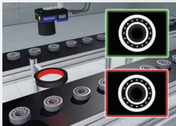
Inspektion von Kugellagern mittels Smart Kamera von Datalogic.
