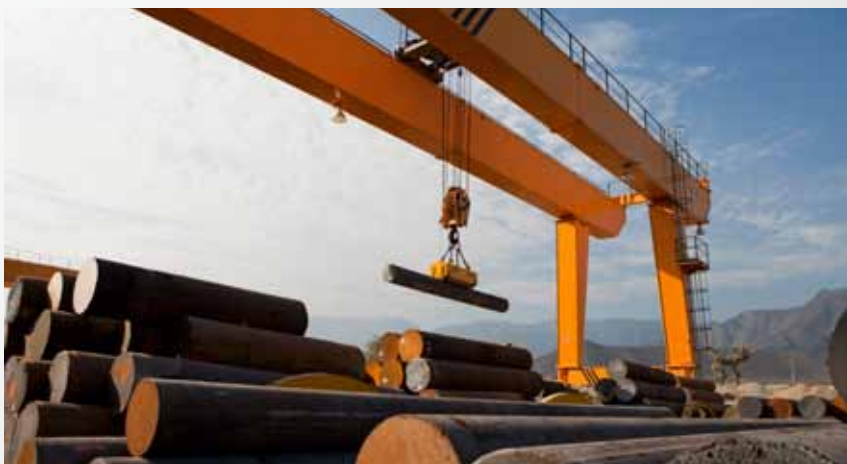
Hebe-Anwendungen mit einem hohen Anteil an bremsenden Bewegungen (beim Herunterlassen) sind prädestiniert für Rückspeiselösungen.
