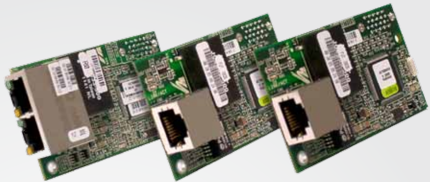
Eine breite Palette an Optionskarten verleiht dem U1000 Matrix-Konverter universelle Kompatibilitätseigenschaften.
