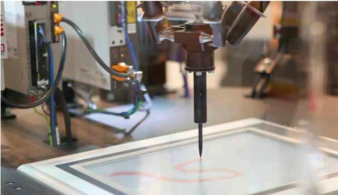
Schnelligkeit und Synchronität des Tripod-Roboters mit gemischten Antriebskomponenten beweisen Geschwindigkeit, Präzision und Herstellerneutralität von POWERLINK
